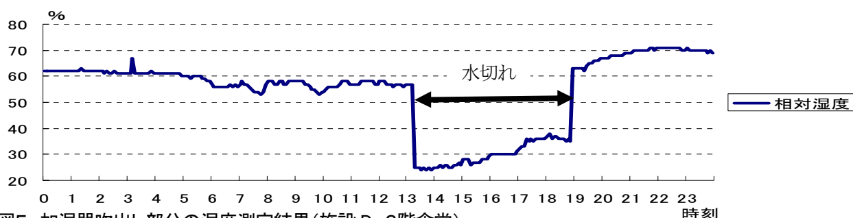
図5 加湿器吹出し部分の湿度測定結果(施設D 2階食堂)
